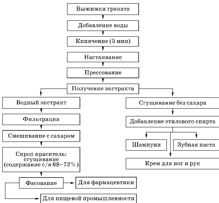
Рис. 82 Технологическая схема получения экстракта и сироп-красителя из выжимок граната
