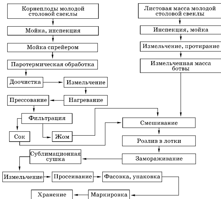
Рис. 67 Структурная схема производства пектинсодержащих продуктов (ПСР)
